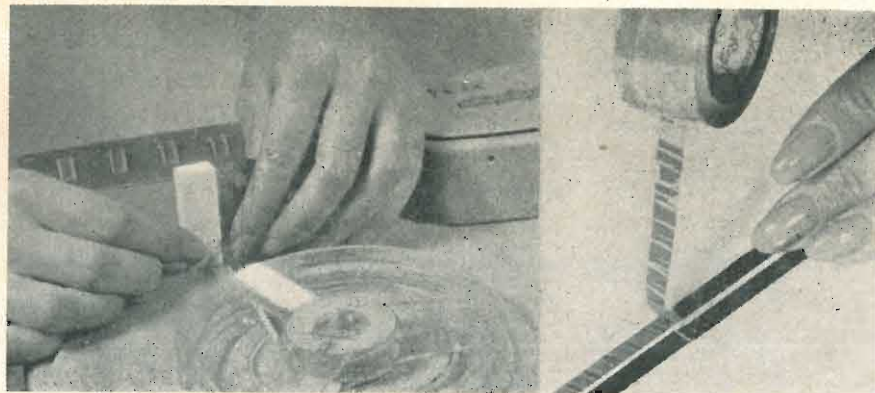
L'estrema resistenza dello strato magnetico dei nastri Agfa permette la loro pulitura facendoli scorrere contro il tagliente di una lama di rasoio (a sinistra). Infine la sostanza magnetica deve aderire perfettamente al supporto. (Tutte le foto sono documentazione Agfa).
