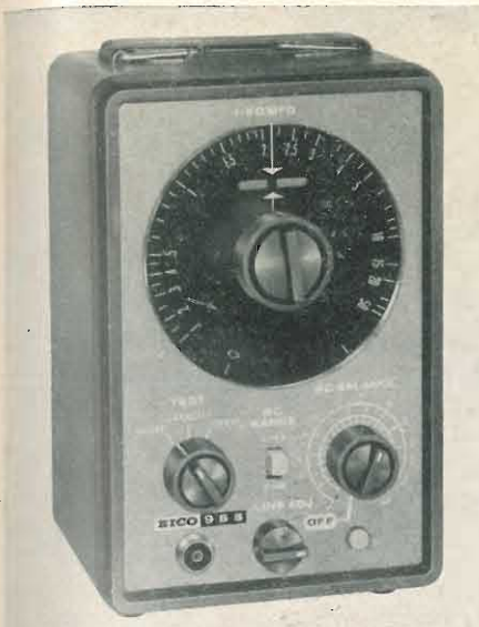
La Erco presenta un piccolo capacimetro che consente misure su condensatori anche montati in circuito. Campo di misura da 0,1 \mu F a 50 \mu F.
